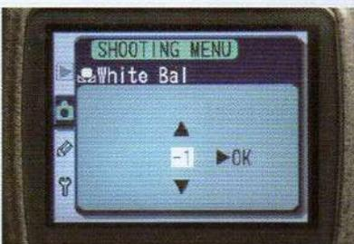
4 Espere a ver el resultado en la pantalla o repita la toma si está sobreexpuesta, subexpuesta o fuera de la gama de compensación (en cuyo caso aparecerá un mensaje de advertencia en la pantalla). Seleccione OK para confirmar el ajuste.
