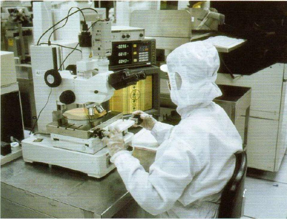
Como en todo proceso de fabricación de productos de silicio, las matrices se verifican para detectar cualquier imperfección. Aquí, un trabajador del fabricante de chips Micron lleva a cabo la comprobación con un microscopio.
