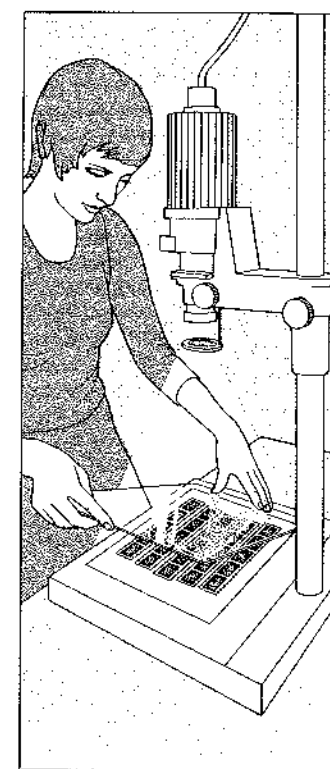
3. Cubra el conjunto con un cristal o, si está usando una prensa de contactos, ciérrela.
